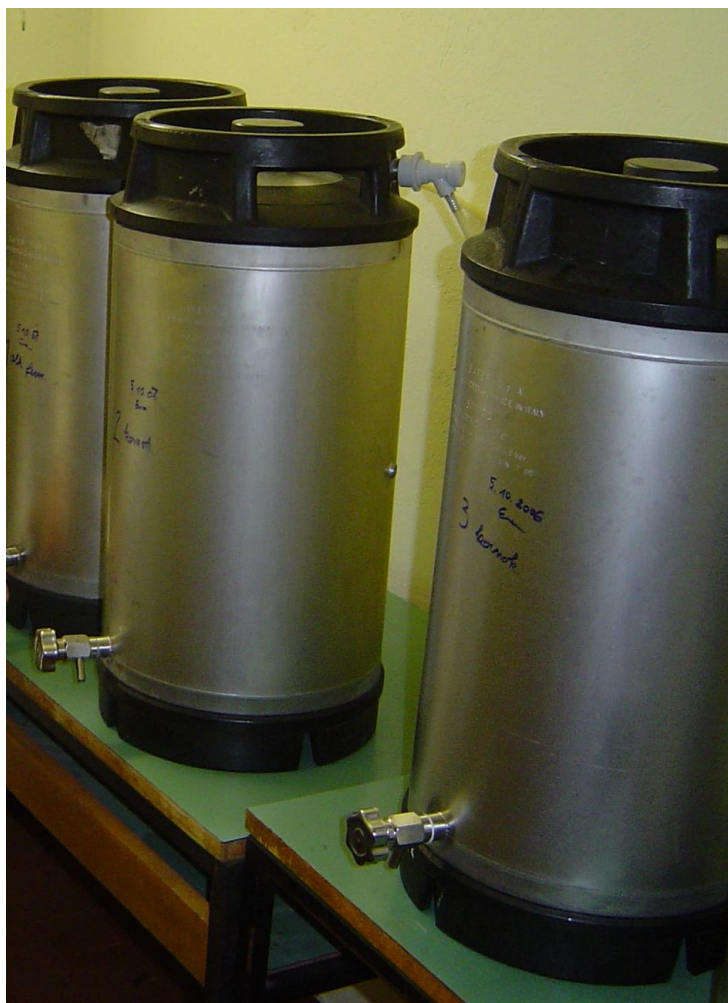
Slika 3: Vrenje v 28 L fermentacijskih posodah
