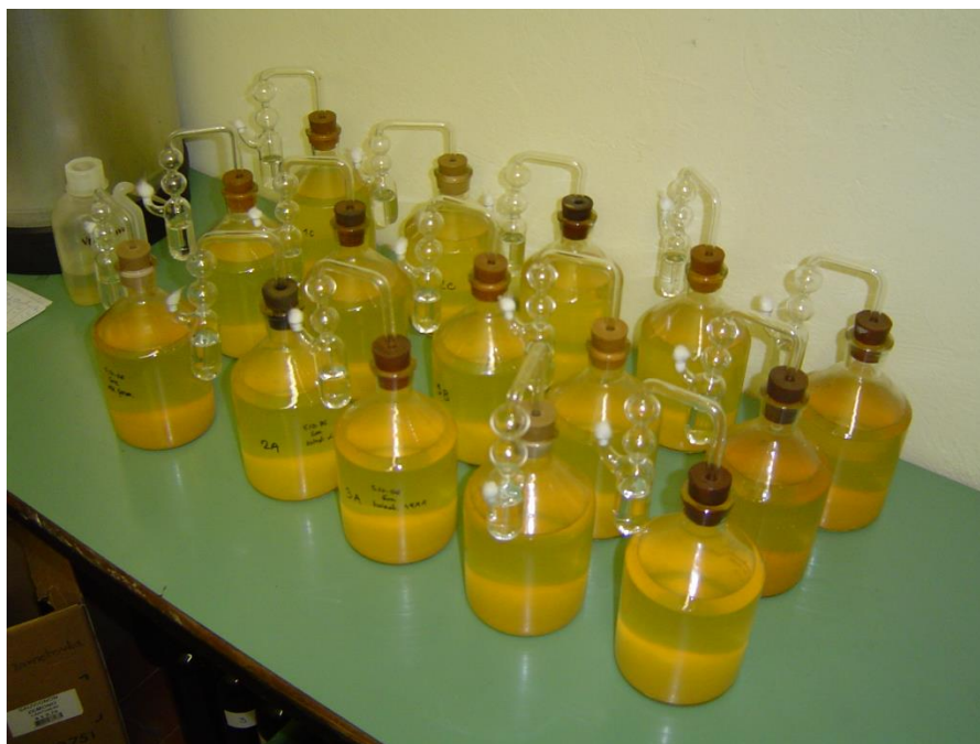
Slika 2: Vrenje v 600 mL fermentacijskih steklenicah
