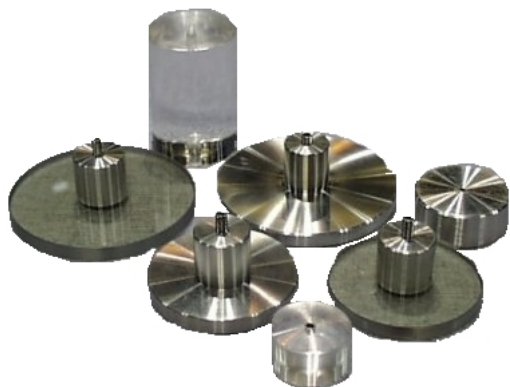
Slika 5: Veliki cilindri za merjenje teksture s stiskanjem (TTC, 2009)
