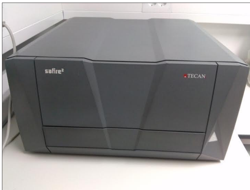
Slika 6: Prikaz mikrotitrskega čitalnika za merjenje absorbance
