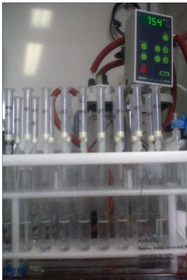
Slika 4: Prikaz kolektorja za ekstrakcijo na trdni fazi, kartuš za ekstrakcijo in vakuumске črpalke
