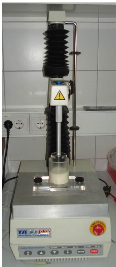
Slika 8: Aparatura za merjenje Texture Analyzer TA.XT Plus z vzorcem omake
