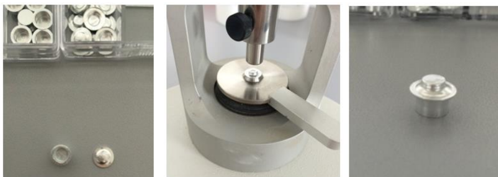
Slika 11: Priprava vzorca na TGA analizo: zapiranje aluminijastega lončka v stiskalnici
