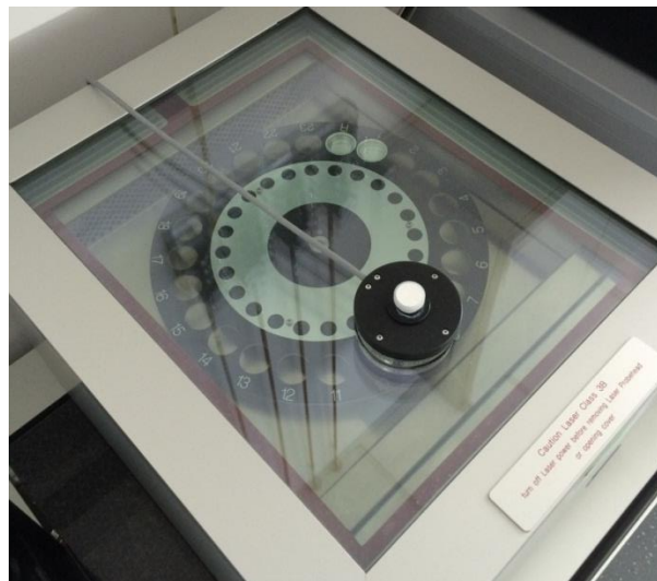
Slika 10: Analizator dinamične sorpcije vode – med analizo z vidnim samodejnim vzorčevalnikom
