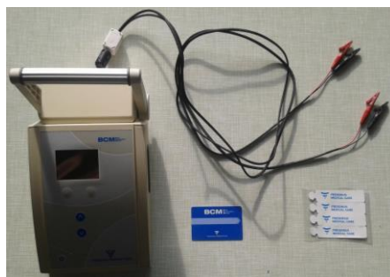
Slika 6: BCM s priključki, podatkovno kartico in s štirimi samolepilnimi elektrodami
