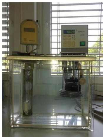
Slika 12: Fotografija sistema za merjenje viskoznosti
