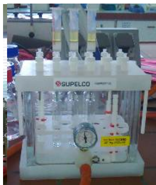
Slika 12: Vakuumski rotavapor in aparatura za izvedbo SPE-postopka
