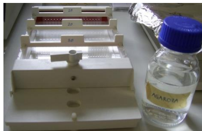
Slika 11: Model za vlivanje gela z glavnički in steklenička z raztopljenim agaroznim gelom
