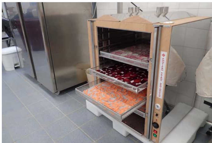
Slika 8: Konvekcijski sušilnik, last Biotehniškega centra Naklo
