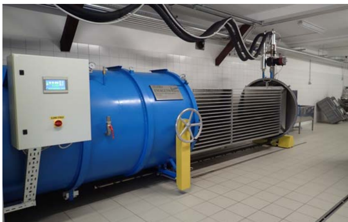
Slika 9: Vakuumski sušilnik Turbo Energetika VSOP-6, last podjetja Hrib d.o.o.
