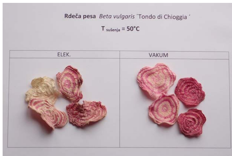
Slika 14: Čips pese 'Tondo di Chioggia' pripravljen pri 50 °C v konvekcijskem sušilniku (levo) in v vakuumskem sušilniku (desno)
