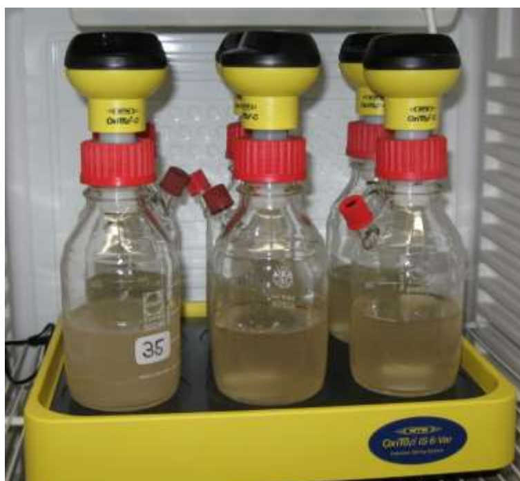
Slika 2: Izvedba poskusa anaerobne fermentacije v bioreaktorjih OXITOP® CONTROL z merilnimi glavami
