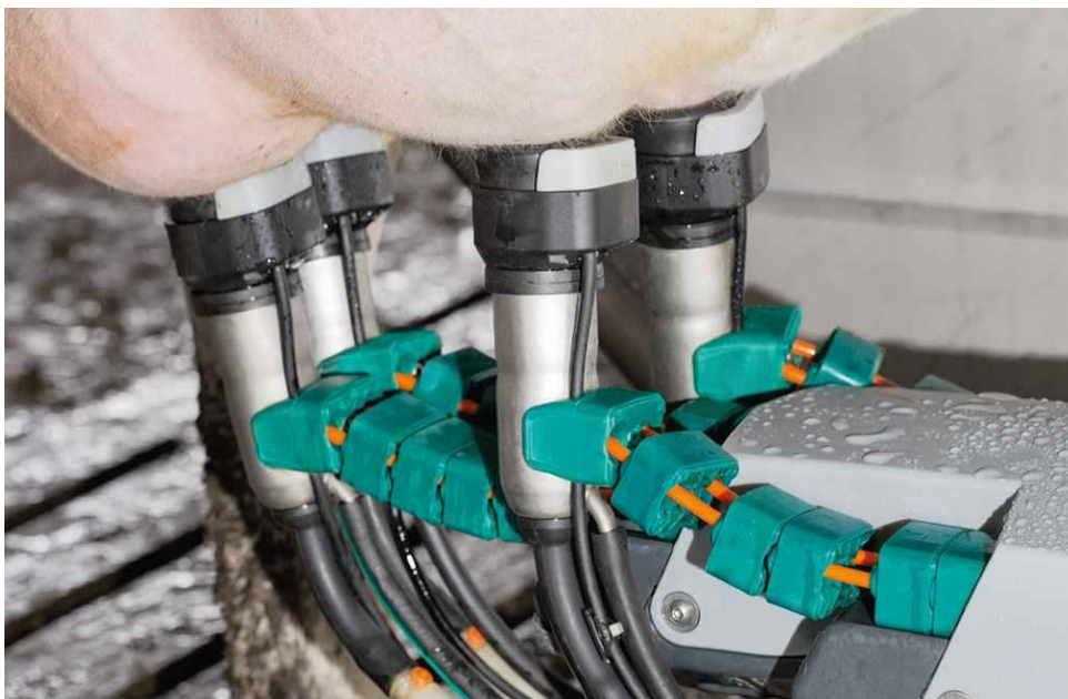
Slika 6: Posebna zaščita molznih čaš (The new generation Mlone, 2015)
