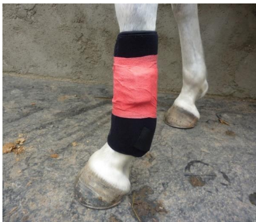
Slika 10: Namestitve naprave x-IMU s samolepljivim povojem
