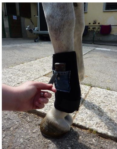
Slika 11: Namestitev naprave x-IMU na prednji ščitnik z uporabo zašitega žepka
