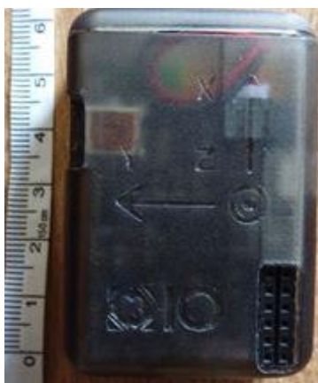
Slika 6: Primer IMU naprave: x-IMU
