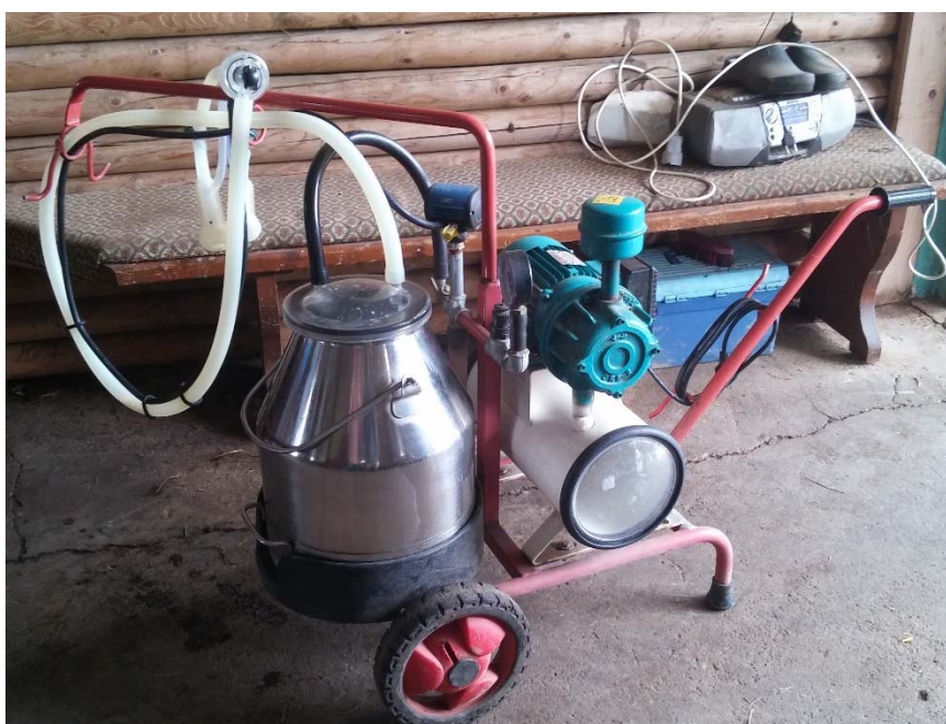
Slika 10: Prenosna molzna naprava namenjena strojni molži kobil (osebni arhiv, 2015)
