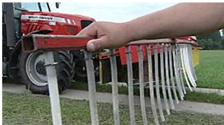
Slika 10: Odganjalec, ki je nameščen na čelni kosilnici (Schutzvorrichtung..., 2011)
