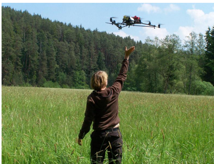
Slika 13: Helikopter z nameščenimi infrardečimi senzorji (Wildretter..., 2013)
