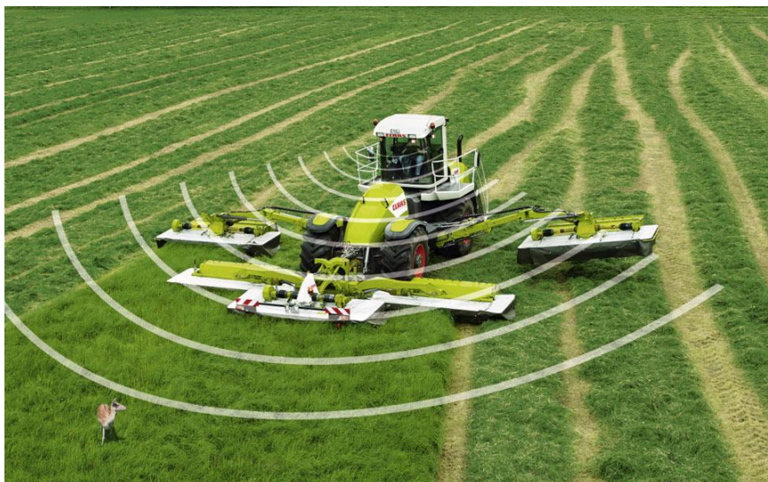
Slika 14: Claasov sistem odkrivanja prostoživečih živali (Claas..., 2013)
