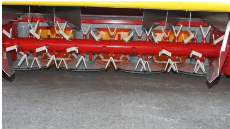
Slika 6: Kosilnica z gnetilnikom (Bobnaste..., 2013)
