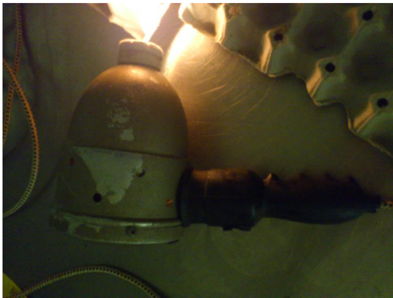
Slika 13: Ovoskop, pripomoček za presvetljevanje jajc (foto: M. Pestotnik, 2013)
