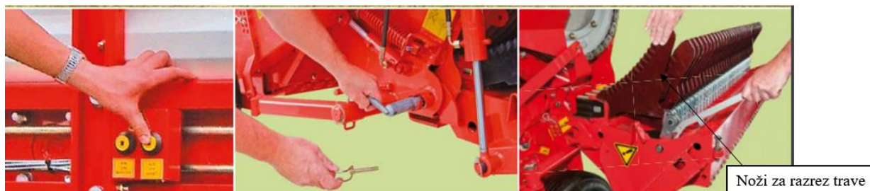
Slika 6: Postopek menjave nožev za razrez trave na nakladalni prikolici Pöttinger Faro 4000 (Pöttinger, 2016).
