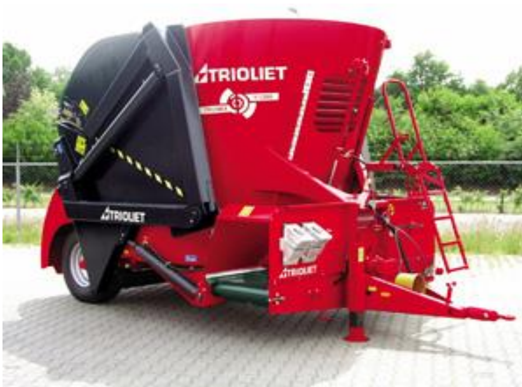
Slika 9: Krmilno mešalna prikolica z lastnim odvzemom (Krmilno-mešalne prikolice..., 2015)
