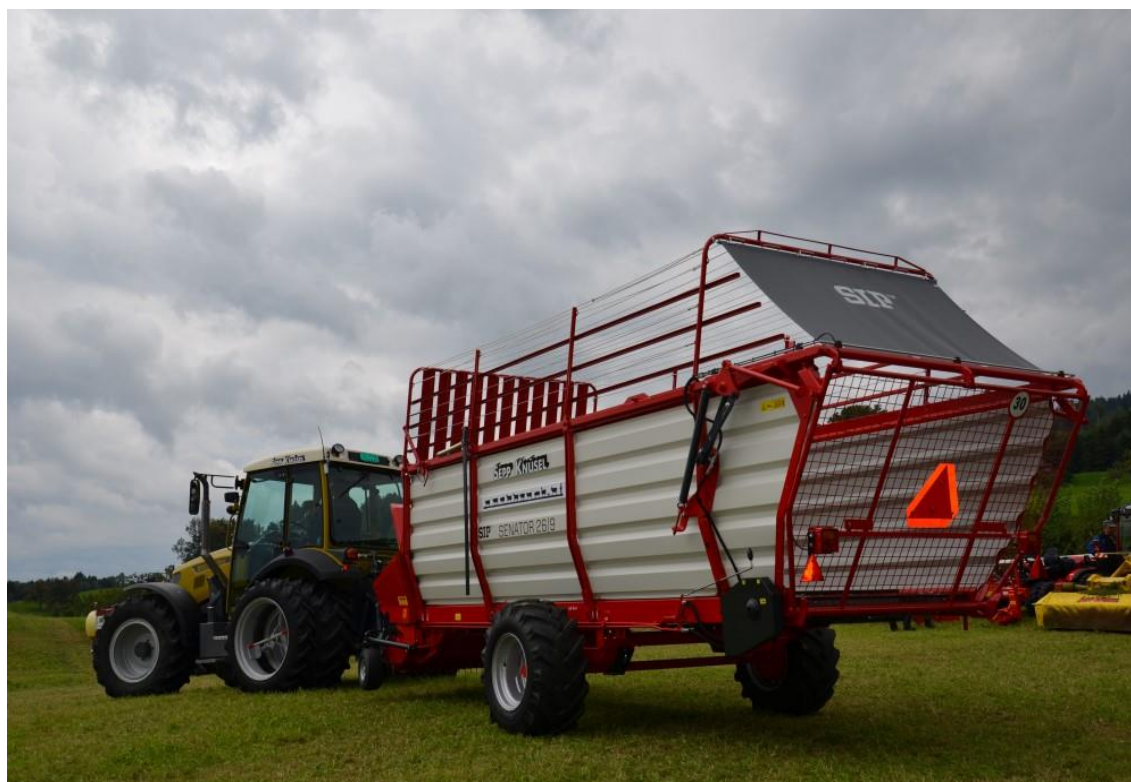
Slika 5: Nakladalna prikolica z nizko tovarno ploskvijo (Nakladalne prikolicе ..., 2016)
