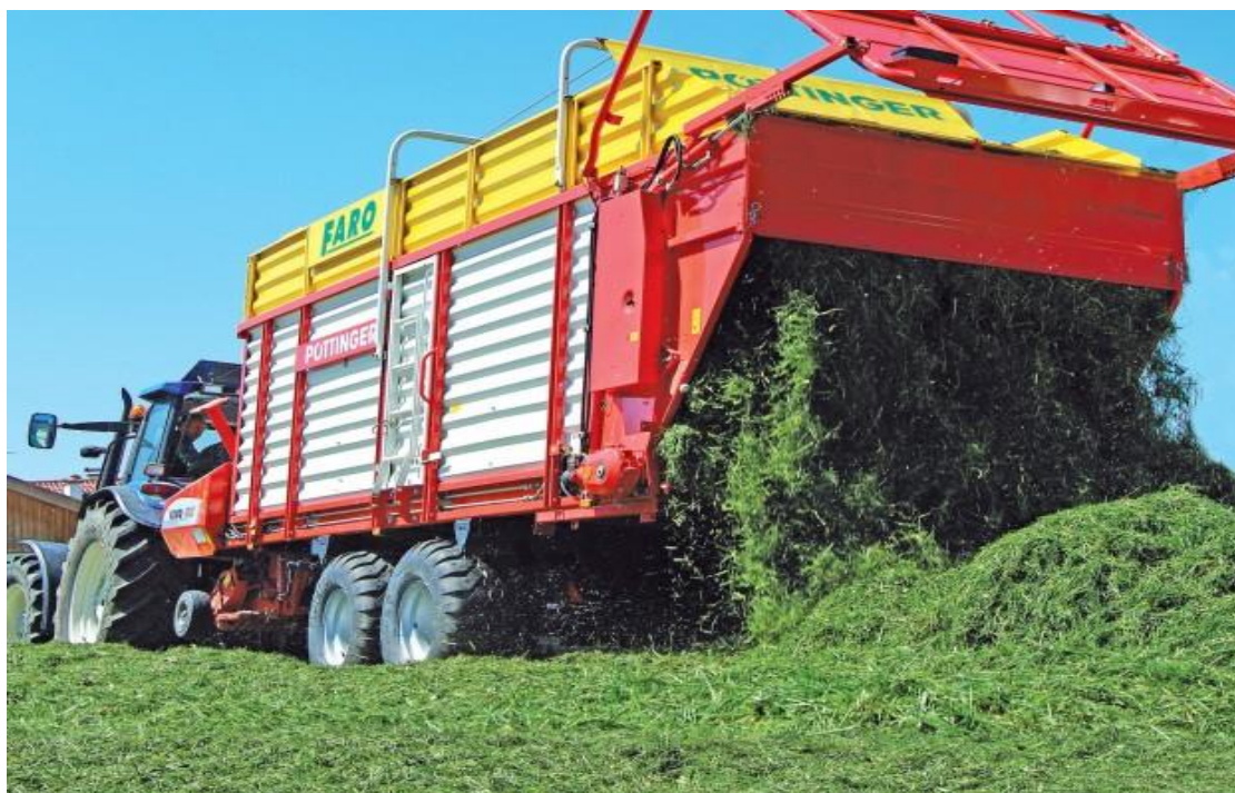
Slika 4: Nakladalna prikolica z visoko tovarno ploskvijo (Samonakladalne prikolicе ..., 2016)
