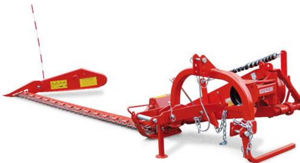
Slika 1: Strižna kosilnica (Bočna strižna kosilnica ..., 2016)
