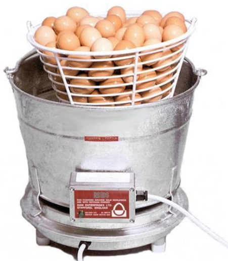
Slika 2: Manjši stroj za pranje jajc (Egg washers, 2012).
